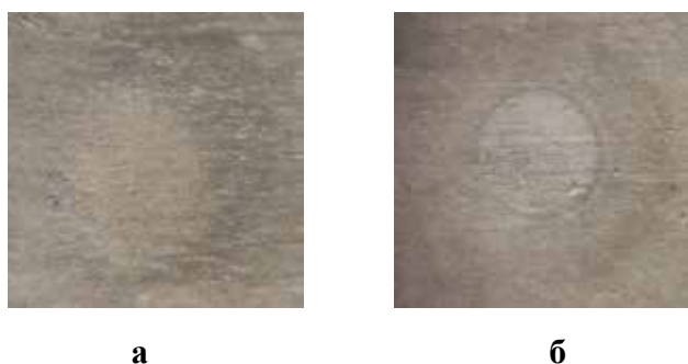
Рис. 3. Фотозображення мідних осадів локально електроосаджених в сульфатному електроліті за час 45 хв з піднятим капіляром діаметром 771 мкм, при густинах струму ( A/дм^2 ): а – 10; б – 30
